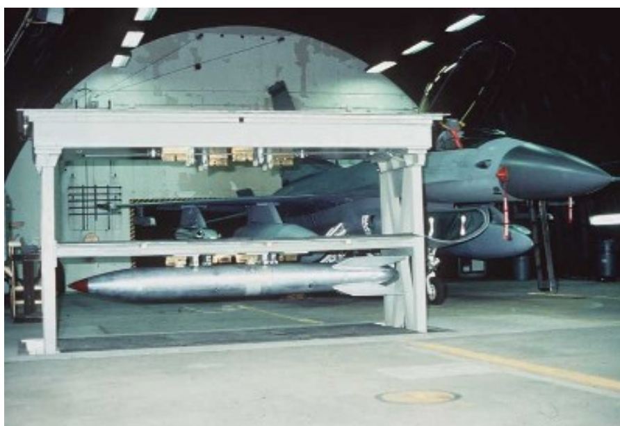
Abbildung 5: versenkbare Lagerungsvorrichtung für Atomwaffen (Nuclear Weapons Storage Vault) in einem Luftschutz Hangar (Protective Aircraft Shelter) im Fliegerhorst Büchel ( http://www.bits.de/public/pressreleases/pr290501e.htm )
